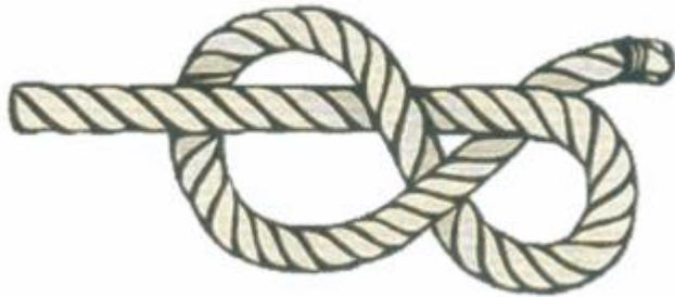
Der Achtknoten wird am Ende eines Seils (Tampen) geknüpft, um den Seildurchmesser zu vergrößern und somit das Durchrutschen aus Rollen oder Ösen zu verhindern.
