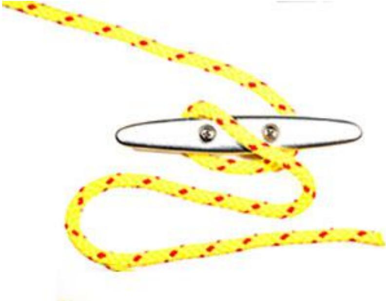
Die Leine geht auf den Nagel der Klampe, der der Zugrichtung gegenüberliegt und wird dann ein Mal um die Klampe herum, unter dem zweiten Nagel durch und kreuzend über die Klampe geführt.
